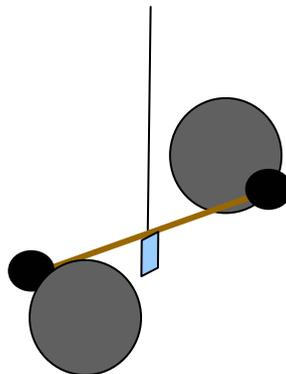
Figure 2 : Le principe de l'expérience de Cavendish avec une balance de torsion. Cavendish a utilisé cette expérience pour déterminer la masse de la Terre.
