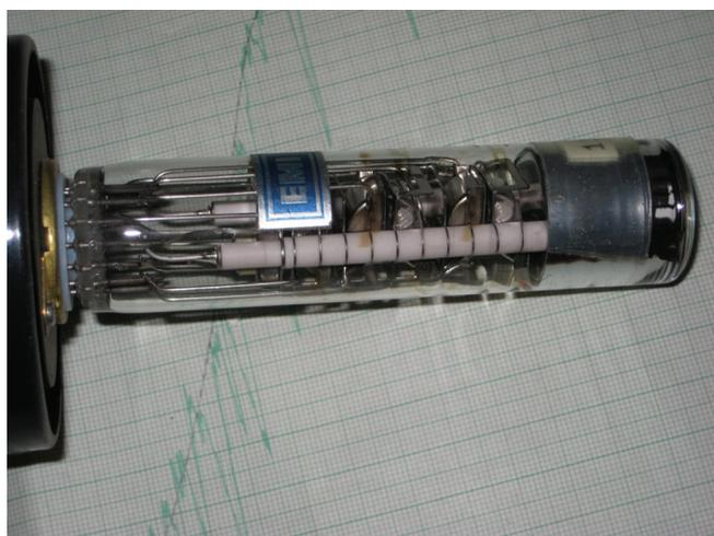
*Figure 4 : Un photomultiplicateur. La cathode réceptrice est sur le bout du tube (à droite). Les étages amplificateurs sont alimentés par des hautes tensions. Le signal de sortie (courant électrique apparaît sur un connecteur du culot. Ces photomultiplicateurs étaient refroidis afin de réduire le courant d'obscurité. Le photomultiplicateur est posé sur un enregistrement direct du signal.*
