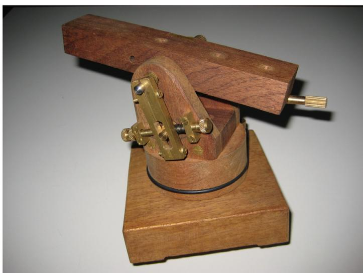
Figure 21 : Système permettant un fin déplacement des jumelles (ou d'une lunette). L'appareil se fixe entre le pied photo et le support des jumelles (Figure 14)
