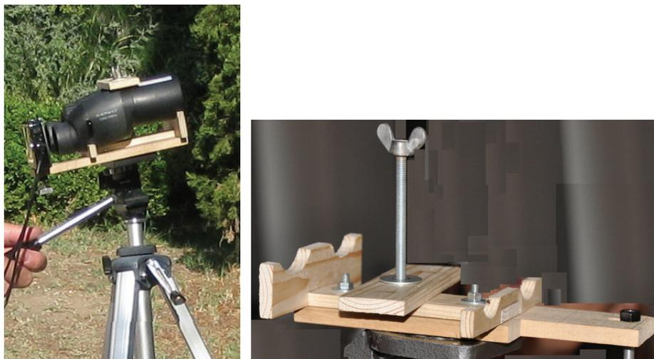
Figure 14 : l'appareil photo numérique monté derrière des jumelles et fixé sur un pied photo, à l'aide d'un petit support bricolé.
