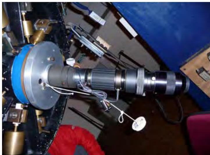
Montage du Led Kollimator sur le T600
