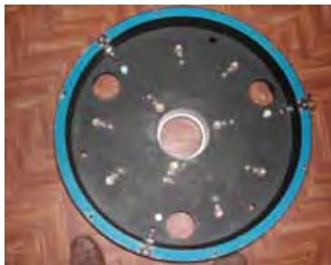
Le principe pour le calcul des leviers est le suivant : la somme des forces appliquées sur les points d'appuis doit être égale au poids du miroir d'après le calcul par éléments finis avec PLOP.EXE
