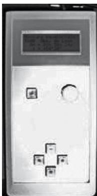
C'est un micro calculateur qui réalise les calculs pour le T600 pour vous, en affichant directement les coordonnées de l'objet recherché, le tout en temps réel. Il est équipé d'une horloge lui fournissant l'heure sidérale. Plusieurs catalogues sont disponibles ainsi que le calcul des éphémérides. Il a la possibilité de connecter 2 codeurs optiques pour faciliter l'utilisation du télescope.
