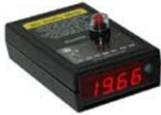
Cet appareil mesure la brillance de fond de ciel (magnitude surfacique) dans un angle de 80 degrés centré perpendiculairement à la façade du boîtier, un photomètre en quelque sorte.
