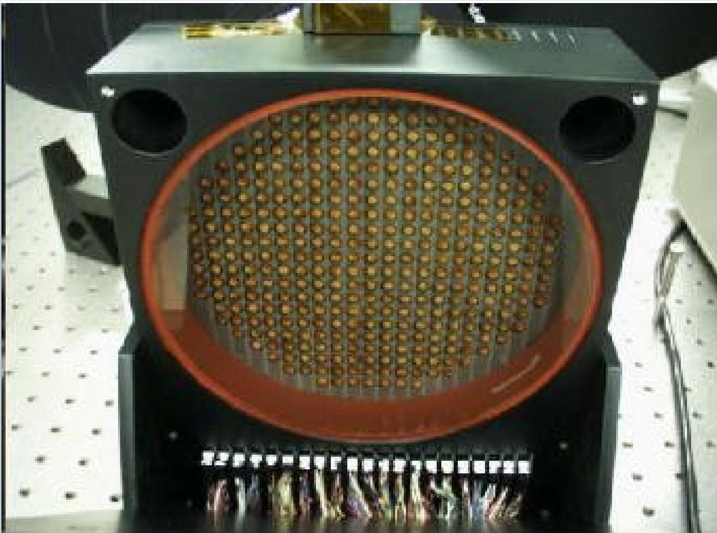
Face arrière du miroir Xinetics utilisé dans le système d'optique adaptative du télescope Keck (349 actionneurs séparés de 7 mm)
