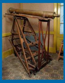
Les deux lunettes à monture azimutale (à gauche) ont un diamètre de 11 cm. Elles ne sont pas signées. Celles de droite sont portées par une monture Cauchoix et signées Bardou et Normand respectivement. Leur diamètre est de 12.5 et 19 cm.
